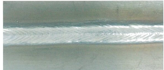
■ Workpiece Material : sus304(6mmt) ■ Wire size : \phi 1.2 ■ Current : 180A ■ Gas : 98%Ar+2% CO 2 ■ Voltage : 23V
